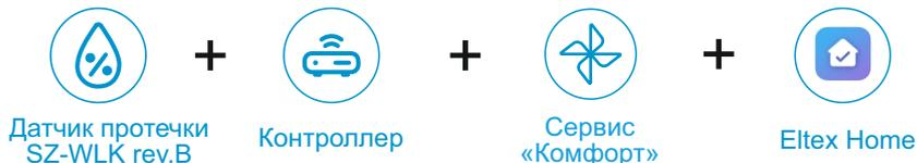
2. Датчик может работать вместе с приводом перекрытия воды. При обнаружении протечки датчиком SZ-WLK rev.B привод автоматически перекрывает воду
